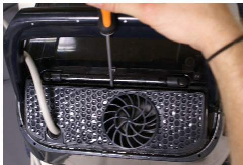
7.1. Za pomocą płaskiego śrubokrętu zdejmij kratkę ochronną.
