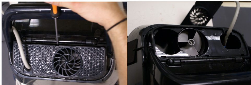
7.1. Bruk en flatskrutrekker for å fjerne beskyttelsesgitteret.
