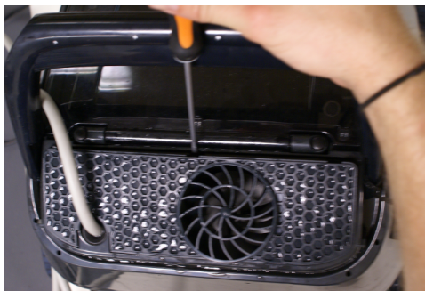
7.1. Käyttäkää tasapääruuvimeiseliä poistaessanne suojaavaa ritilää.
