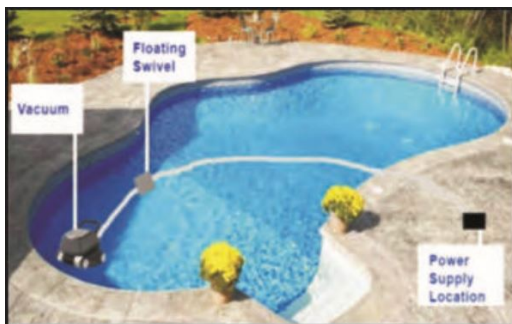
4.3 Plasser strømforsyningen ved midtpunktet mellom de to ender av bassenget og minst 3,50 m fra kanten av bassenget.
